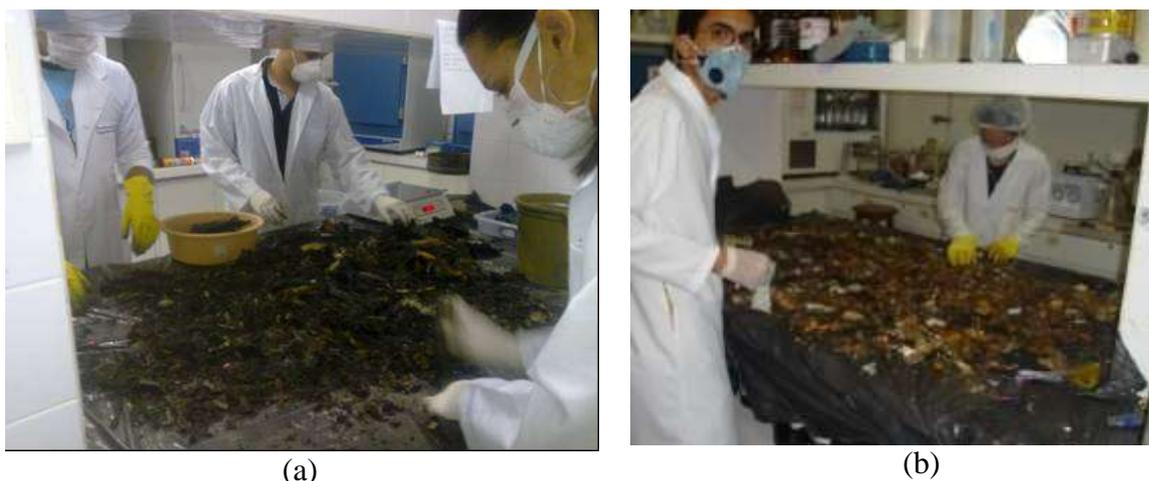
Figura 4.7. Ensaio de caracterização gravimétrica dos (a) resíduos em avançado estado de decomposição no laboratório sobre bancada
