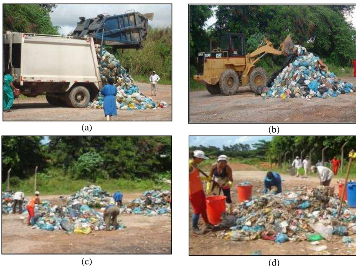
Figura 4.2. Etapas para obtenção de amostras envolvendo (a) descarrego do caminhão coletor de RSU; (b) pré-homogeneização dos RSU e (c) processo de quartejamento e (d) separação da amostra para caracterização
