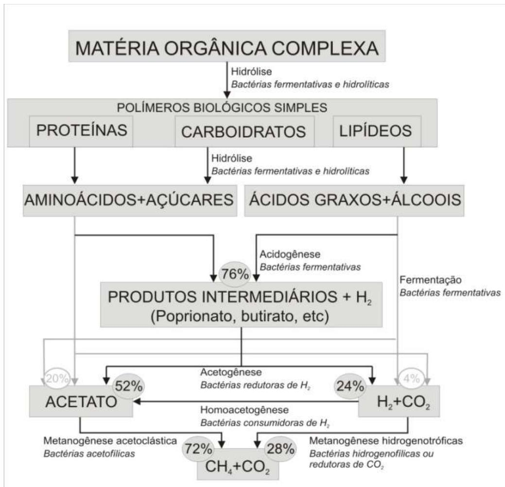
Figura 2.7. Esquema das reações na digestão anaeróbia de materiais poliméricos formados por cadeias de carbono (adaptado de Lobo *et al.*, 2003b)
