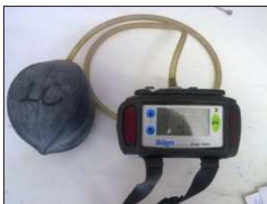
Figura 6.10. Medição da composição do gás utilizando o analisador de biogás *Drager modelo X-am 7000*
