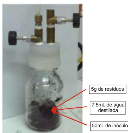
Figura 5.2. Quantidade de resíduo, água destilada e inóculo utilizada na realização do ensaio BMP
