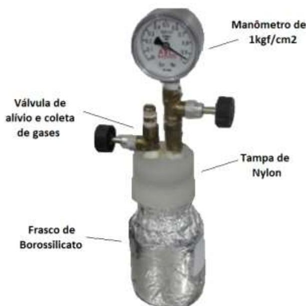
Figura 5.1. Biorreatores utilizados para a realização do ensaio BMP
