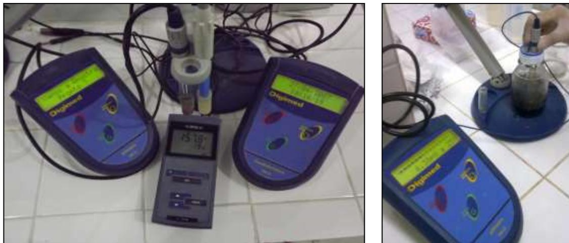
Figura 4.9. (a) Medição do pH e (b) potencial redox no início e no final do ensaio BMP
