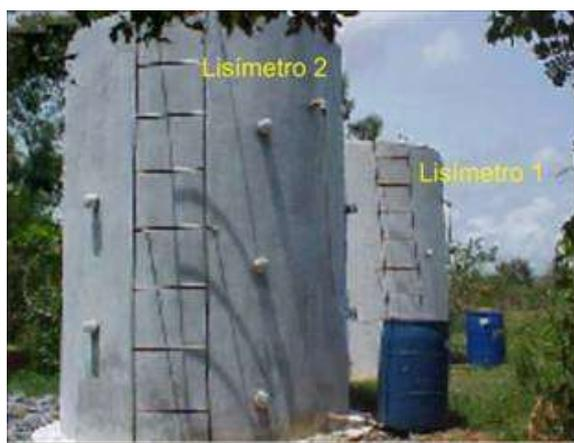
Figura 4.4. Lisímetros em operação construídos no aterro da Muribeca (ALCÂNTARA, 2007)
