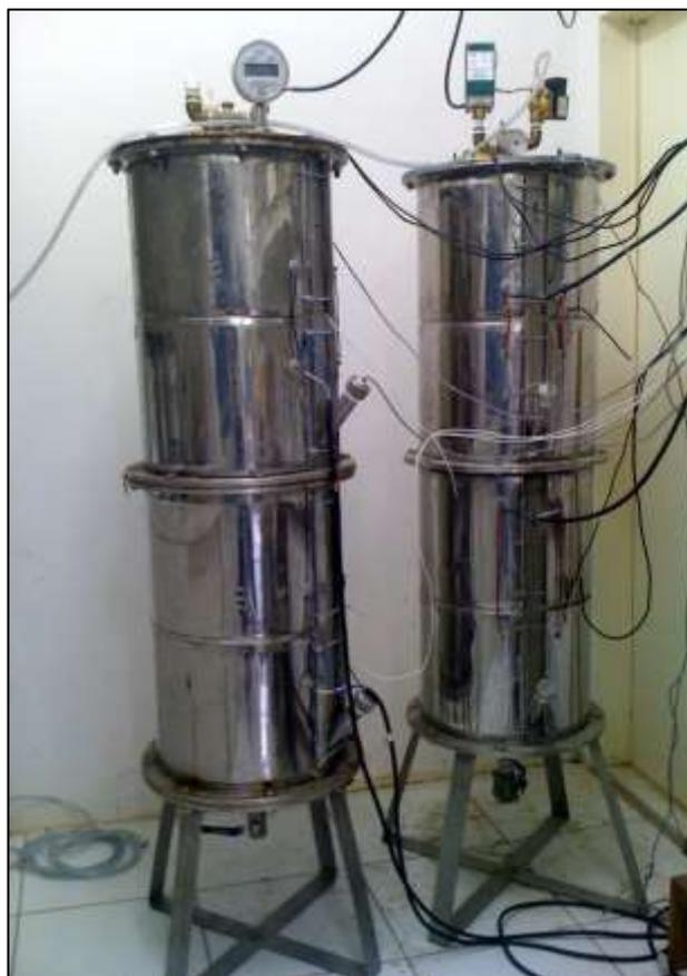
Figura 6.1. Reatores piloto 1 e 2 construídos no Laboratório de Geotecnia Ambiental da UFPE
