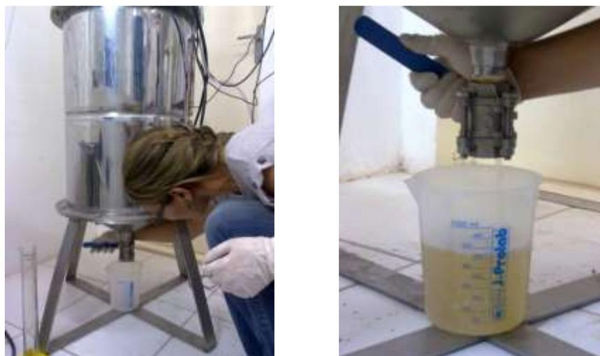
Figura 6.6. Detalhe da instrumentação para coleta de lixiviado na parte inferior do reator piloto
