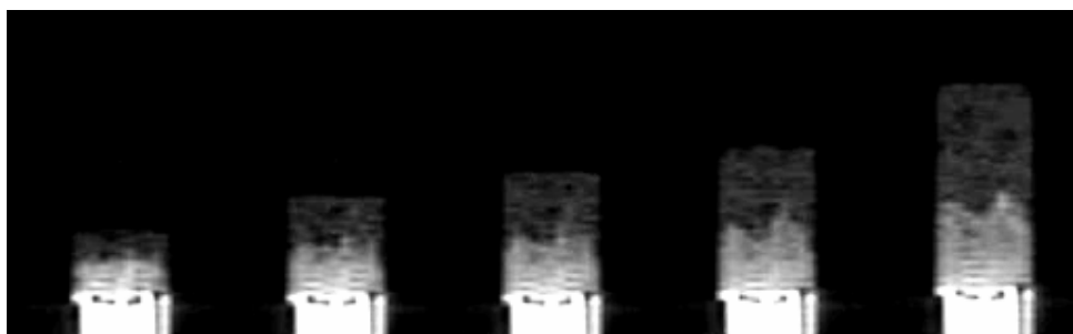
Figura 5.7. Montagem das imagens de RMN da entrada de água de uma amostra de filtro de papel prensada com 27,5 MPa para diferentes tempos: 10, 47, 93, 157 e 433 min.
