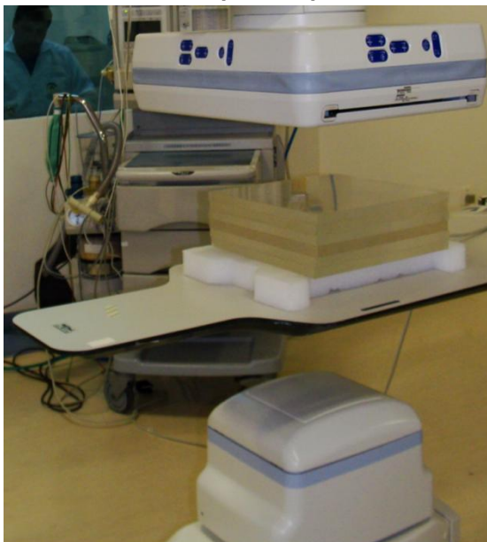
Figura 28 – Arranjo experimental utilizado para o teste da taxa de kerma no ar na superfície de entrada da pele do paciente
