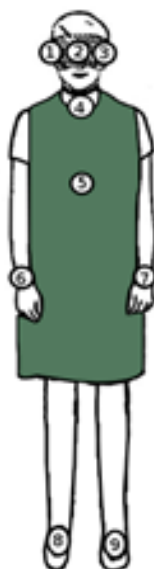
Figura 33 – Posicionamento dos dosímetros no médico
