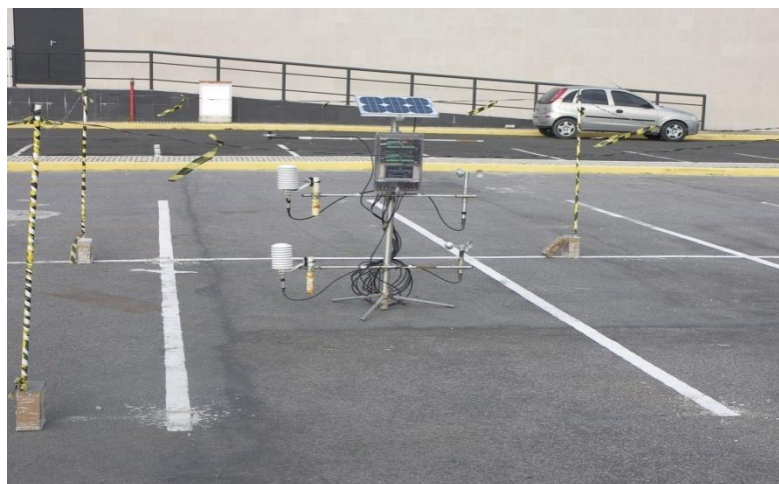
Figura 7. Torre micrometeorológica instalada na área com cobertura asfáltica na cidade do Recife, PE.
