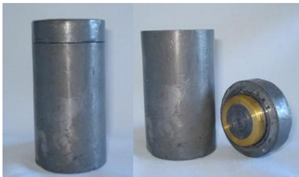
Figura 6 – Ilustração do cilindro de chumbo com 6 mm de espessura utilizado na realização das medidas.
