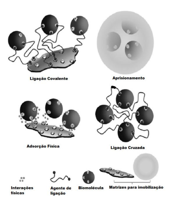
Figura 1. Métodos de imobilização de biomoléculas (adaptado a partir de Bickerstaff, 1997).
