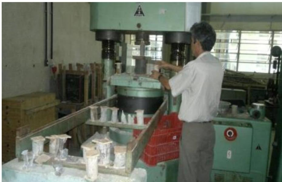
Figura 21. Equipamento utilizado para o ensaio de compressão uniaxial, com uma capacidade de carregamento de até 300 toneladas.
