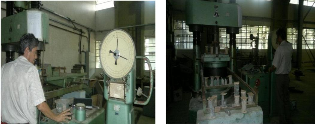
Figura 22. Determinação e leitura da carga aplicada
