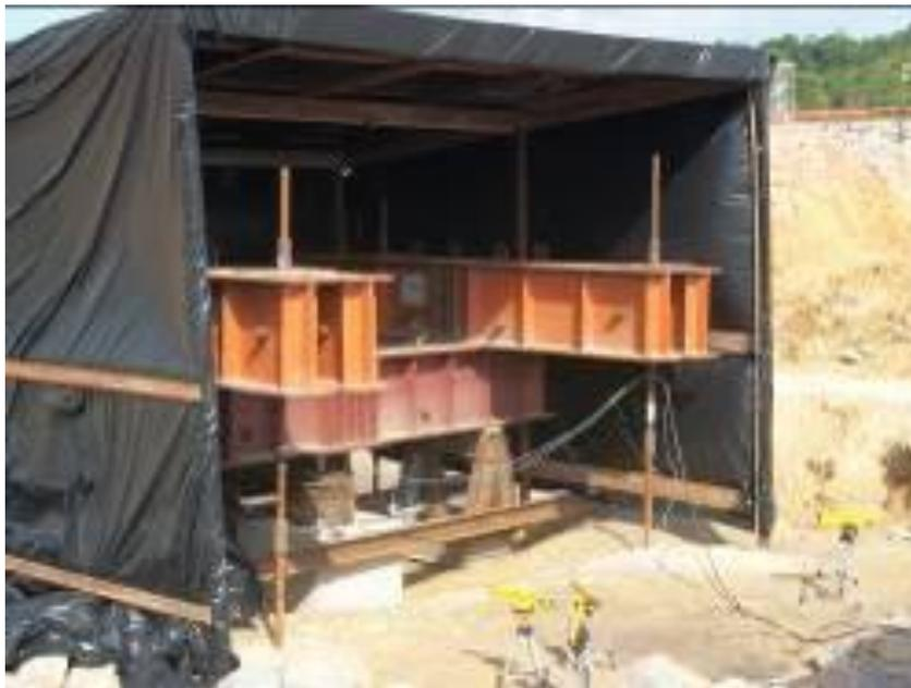
Figura 40. Níveis laser para medir deslocamentos das estacas de reação
