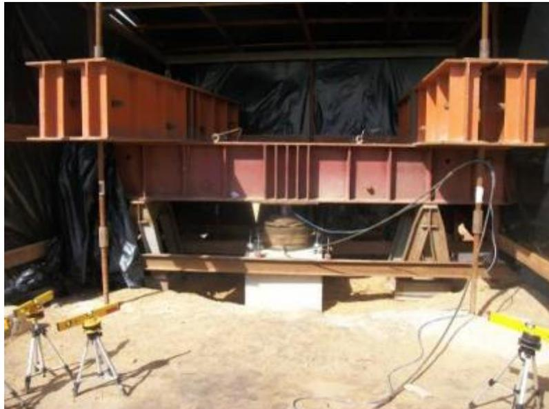
Figura 37: Sistema de reação.
