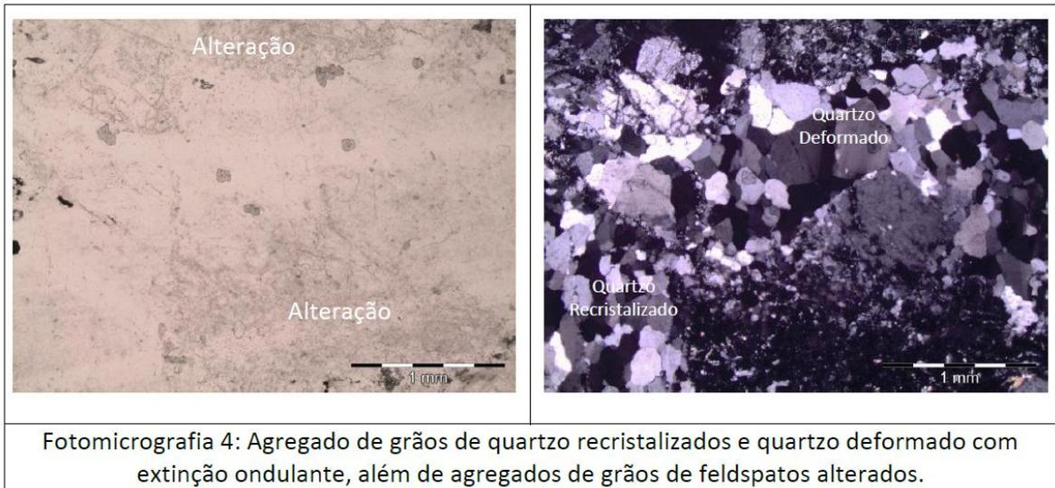
Fotomicrografia 4: Agregado de grãos de quartzo recristalizados e quartzo deformado com extinção ondulante, além de agregados de grãos de feldspatos alterados.
