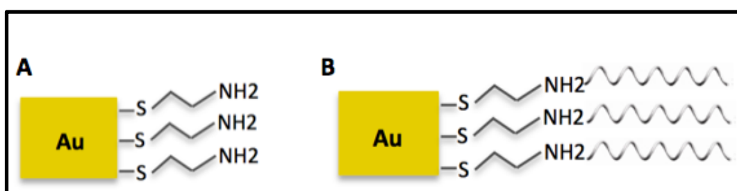
Figura 10. Processo de imobilização de ácidos nucleicos a partir de uma monocamada de grupamento tiol presente no aminoácido cisteína. A) Eletrodo de ouro modificado a partir de uma monocamada de grupamento tiol; B) Eletrodo de ouro modificado a partir de uma monocamada de grupamento tiol imobilizado com uma sonda de DNA.
