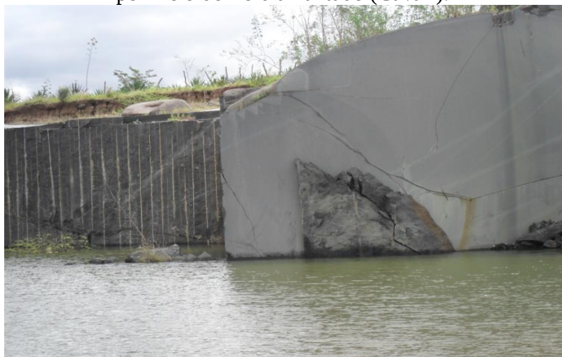
Foto 3.4 ã Abertura das faces livres apresenta o uso de tecnologias de corte em costura e por meio do fio diamantado (Cava I).
