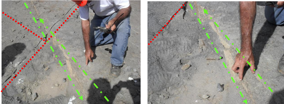
Foto 2.3 ã Detalhe no topo do maciço onde é possível ver a continuidade da fratura de cisalhamento (linha verde) que cruza o corte produzido pelo fio diamantado (linha vermelha)
