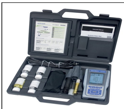
Figura 4. Equipamento OAKTON, modelo WP 600, série Meters
