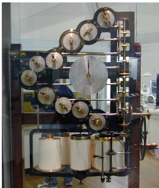
Figura 32 – Primeira máquina para previsão de maré
