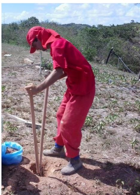
Para realização dos ensaios de sucção e permeabilidade à água e ao ar retirou-se uma amostra indeformada de cada camada, em moldes de PVC de 0,10 m de diâmetro e 0,15 m de altura (Figura III.5).
