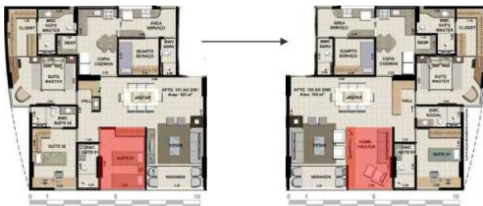
Figura 4.5. À esquerda, PO C1b1; à direita, PO C1b2. Destaque para o quarto que se transforma em home theater .
