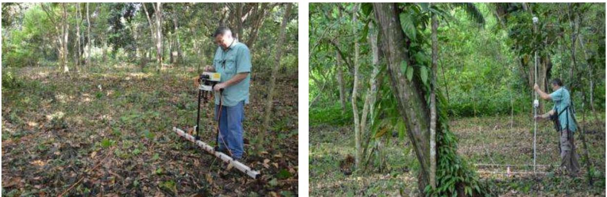
Figura 7: Uso do *Fluxgate Gradiometer* e do *GEOSCAN RM-15D Resistivity Meter* (respectivamente).
