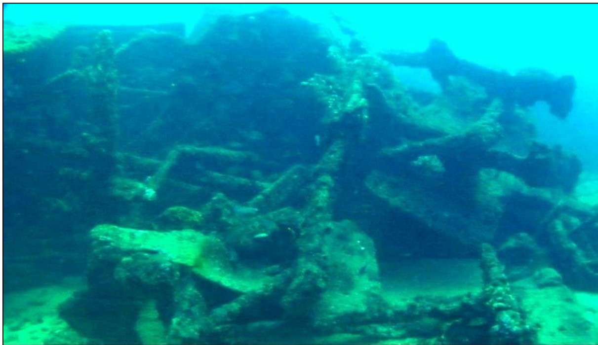
Figura 19. Roda-de-pás de boreste desmantelada com algumas pás e vigas partidas. Foto: Max Glesgyson (Dolphin Eye), 2013.
