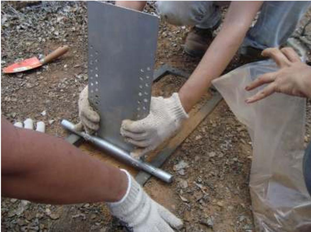
**Figura 08:** *Scrape Plate* utilizado para coleta de amostras para análise de Cs-137 com incremento a cada 3 cm de profundidade. Foto: Diogo Galvão, nov./2011.
