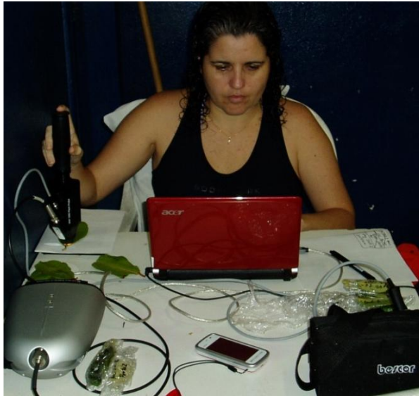
Figura 02: Aquisição de dados da espectrorradiometria na folha de mangue.
