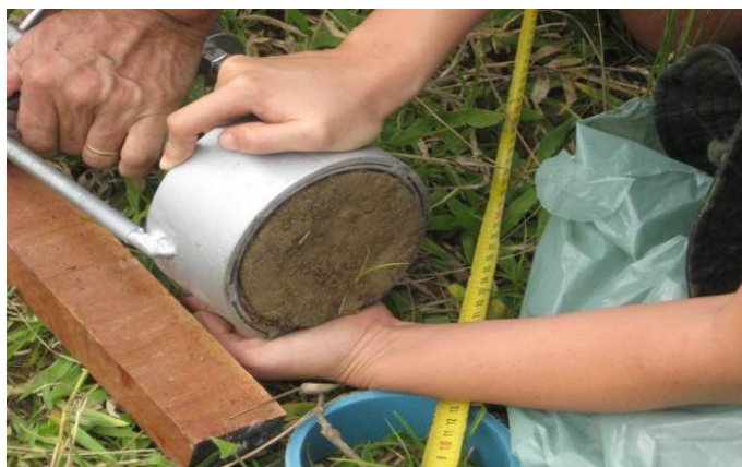
Figura 17. Execução do fatiamento do solo.
