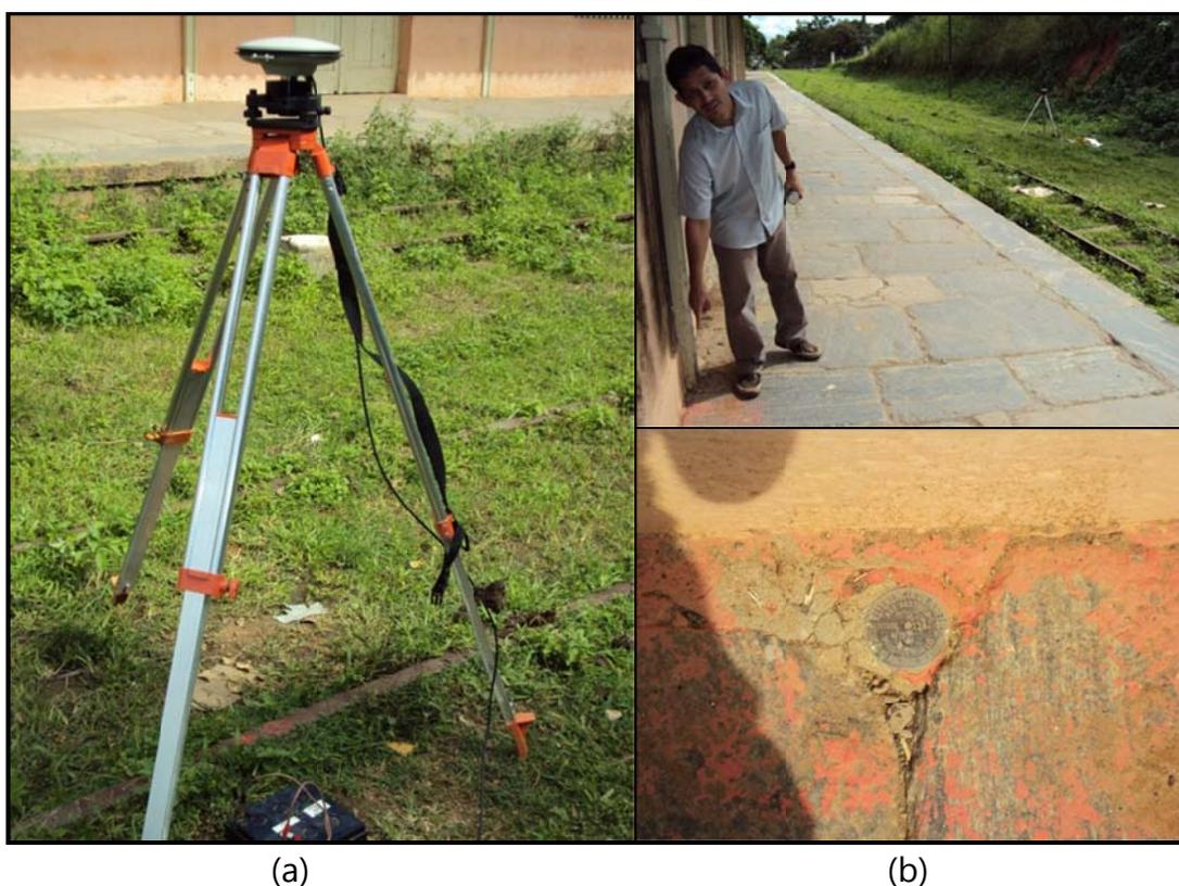
Figura 33 – (a) RN<sub>Trilho</sub> utilizada como base do levantamento. Fonte: Autor.
