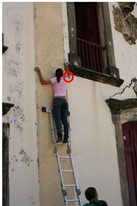
Figura 24: Altura máxima para fixação dos alvos, com a equipe no exterior da Igreja
