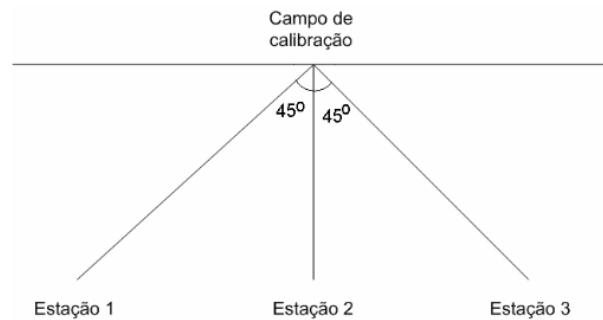
FIGURA 2: Esquema das estações de tomada das fotografias pelo método de câmara convergente
