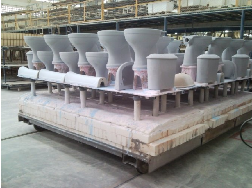
Figura 12 - Disposição das louças sanitárias na vagoneta antes do processo de sinterização.
