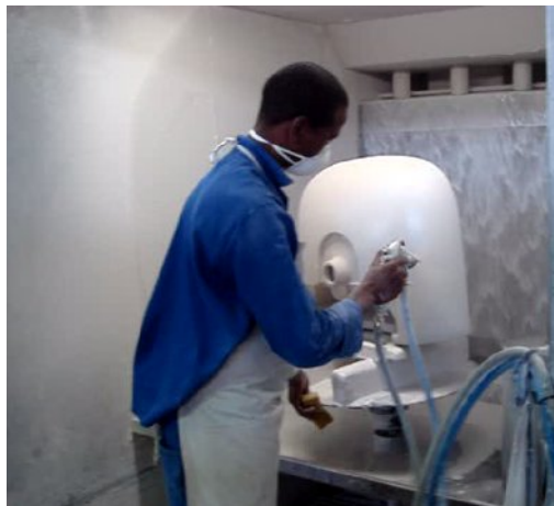
Figura 10 - Processo de aplicação de vidrado cerâmico em um corpo cerâmico.
