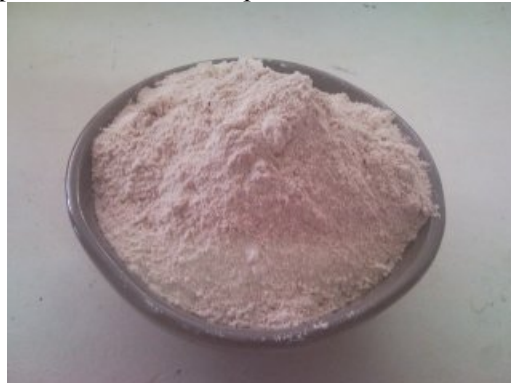
Figura 4 - Feldspato beneficiado em peneira ABNT nº 200 (abertura 74\text{ }\mu\text{m} ).
