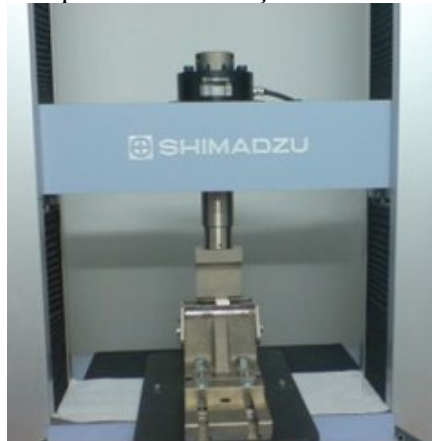
Figura 17 - Dispositivo para a determinação do módulo de ruptura a flexão.
