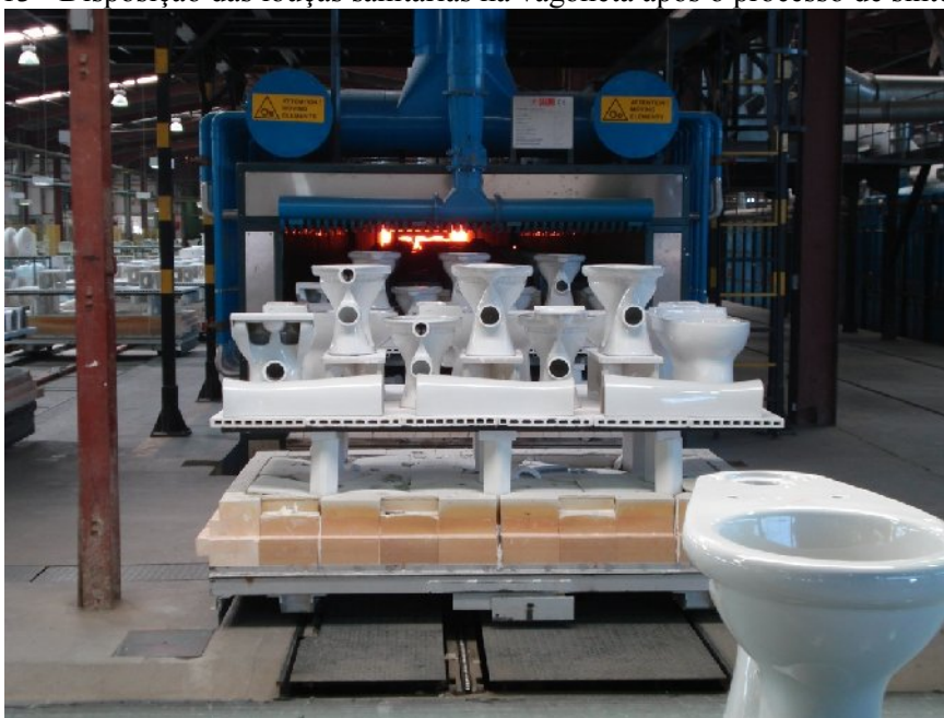
Figura 13 - Disposição das louças sanitárias na vagoneta após o processo de sinterização.
