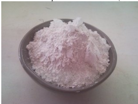
Figura 3 - Quartzo beneficiado em peneira ABNT nº 200 (abertura 74 \mu\text{m} ).
