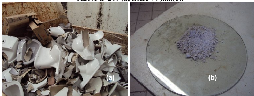
Figura 5 - Resíduo bruto de louça sanitária(a); resíduo de louça sanitária beneficiado em peneira ABNT nº 200 (abertura 74 \mu m)(b).
