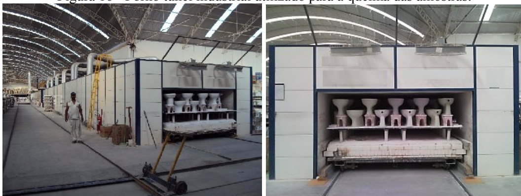
Figura 16 - Forno túnel industrial utilizado para a queima das amostras.
