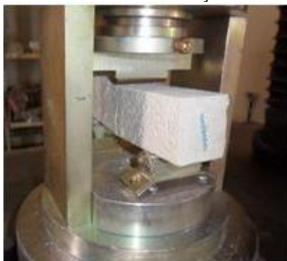
Figura 18 - Determinação da resistência a tração na flexão NBR 13279 (2005).
