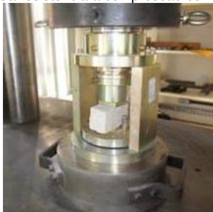
Figura 19 - Determinação da resistência a compressão com corpo de prova prismático.
