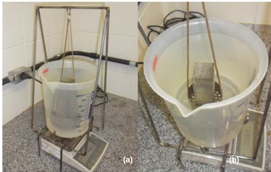
Figura 12 - Pesagem de corpo de prova em balança hidrostática para avaliação da absorção de água.
