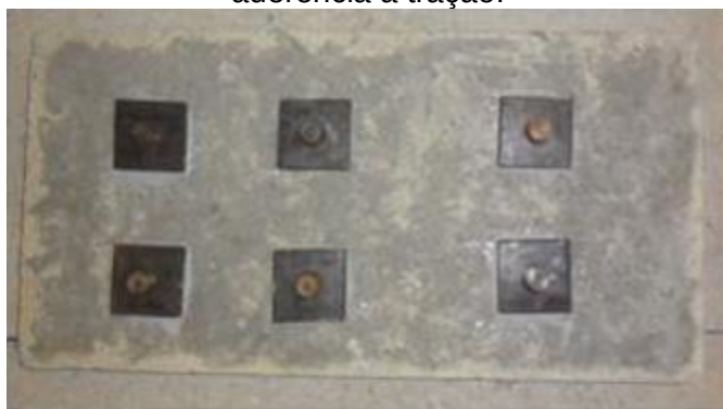
Figura 20 - Ensaio de caracterização do lote de SP, pastilhas coladas para ensaio de aderência à tração.
