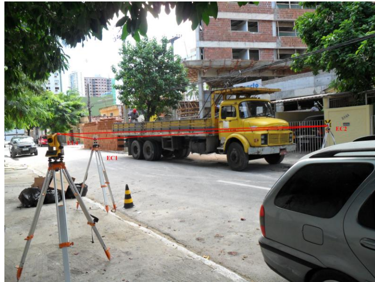
Figura 41 – Configuração dos vértices EC1 e EL4 para a determinação da terceira linha de prumo vertical em relação ao primeiro pavimento.
