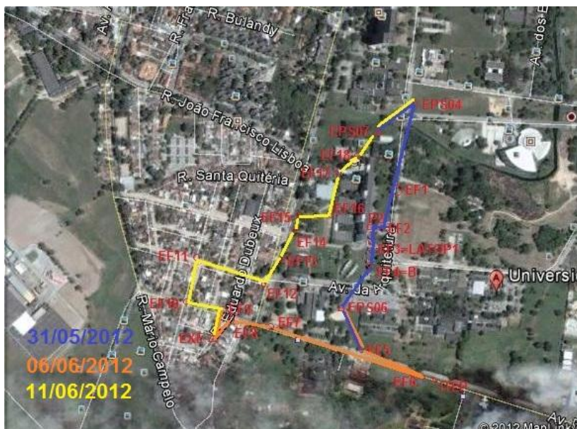
Figura 46 – Esboço em vista aérea da Poligonal completa da área teste 2-CAMPUS RECIFE - UFPE.
