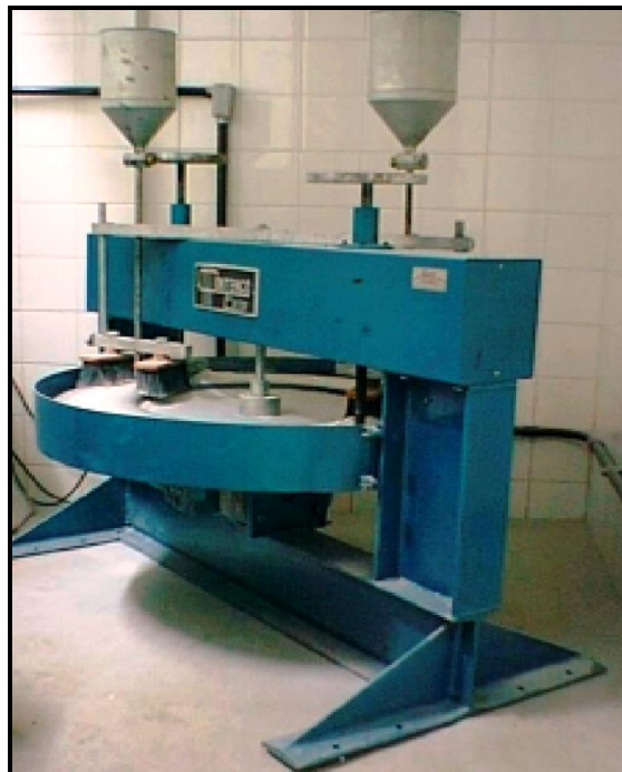
Figura 18 – Equipamento de ensaio para determinação do desgaste por abrasão tipo Amsler. Disponível em: http://www.cpmtec-igc-ufmg.org . Acesso: 03.2013.
