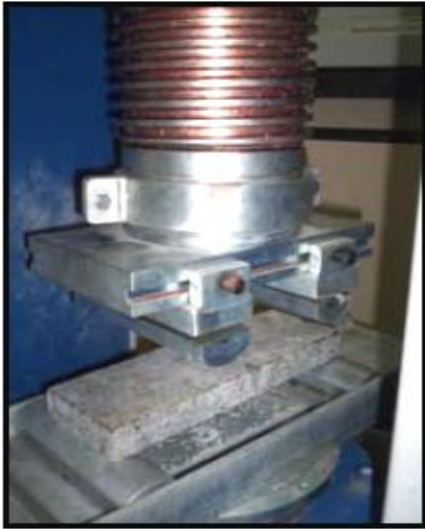
Figura 17 – Prensa Hidráulica utilizada no ensaio de Flexão por Carregamento 3 pontos, detalhe do ensaio (1); Estufa ventilada para secagem de amostras (2). Fonte: Ribeiro, 2008.
