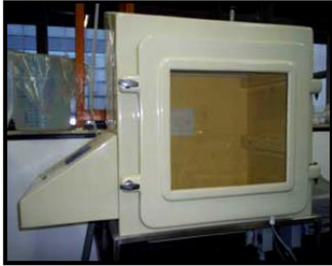
Figura 17 – Prensa Hidráulica utilizada no ensaio de Flexão por Carregamento 3 pontos, detalhe do ensaio (1); Estufa ventilada para secagem de amostras (2). Fonte: Ribeiro, 2008.
