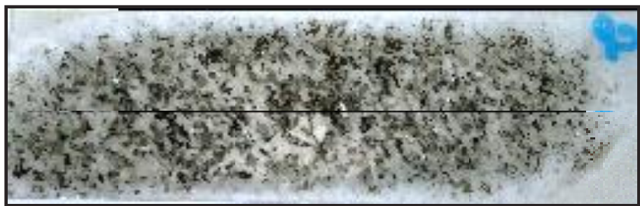
Figura 14 – Lâmina de seção delgada para análise petrográfica. Fonte: Autor, 2013.
