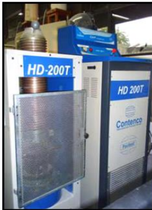
Figura 16 – Prensa Hidráulica utilizada no ensaio de Compressão Uniaxial Simples. Fonte: Ribeiro, 2008.
