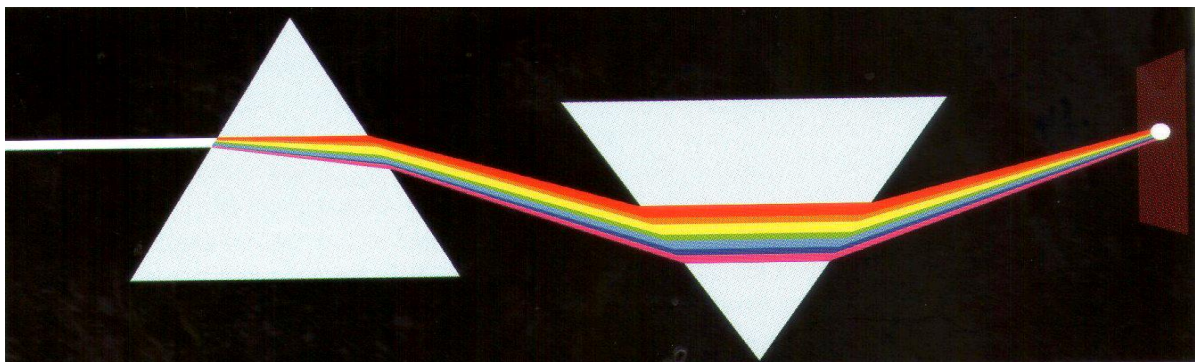
Figura 05 - Espectro visível resultante da incidência da luz branca no prisma. Fonte: Pedrosa, 2010, apud. Santos, 2012, p.37.
