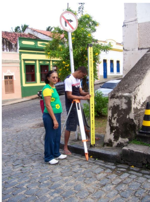
Figura 4.29 – Mira de Vante sobre a RNSP e fechamento do nivelamento geométrico. Foto: Julho 2011.
