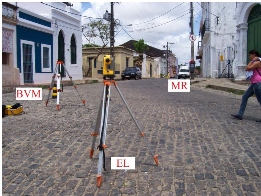
Figura 4.66 – Configuração geométrica dos vértices EL, BVM e MR. Foto: Dezembro 2011.
