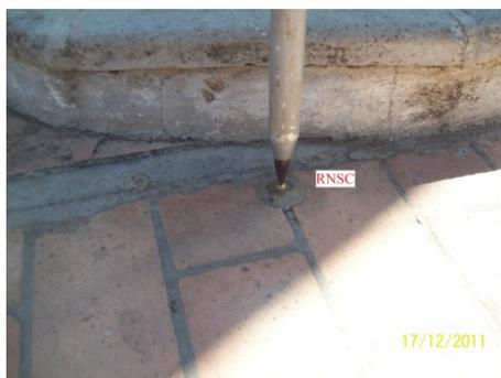
Figura 4.51 – RNSC e superfície de contato com o bastão verticalizado. Foto: Dezembro 2011.
