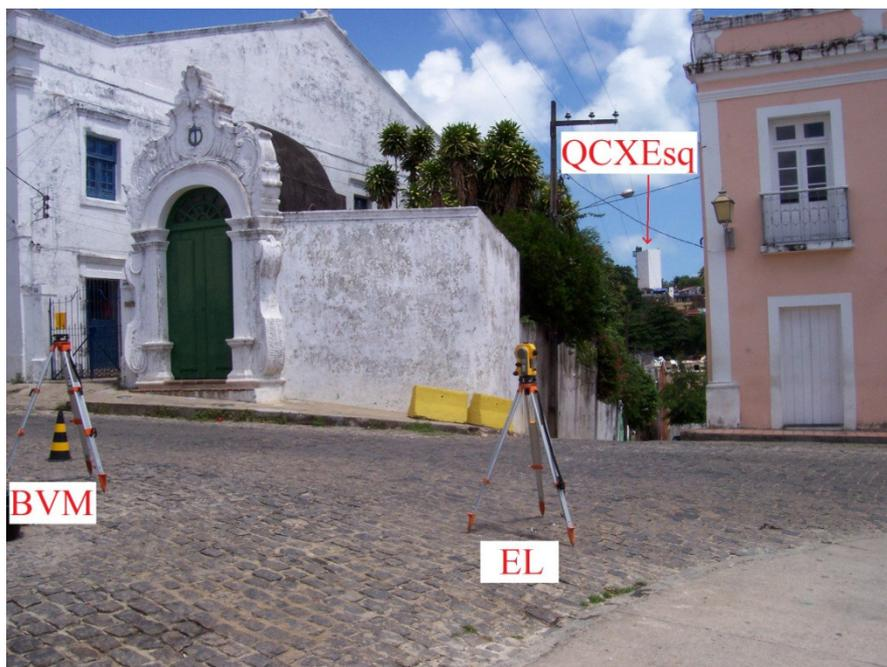
Figura 4.67 – Configuração dos vértices EL e BVM e vista para a Caixa D'água. Foto: Dezembro 2011.
