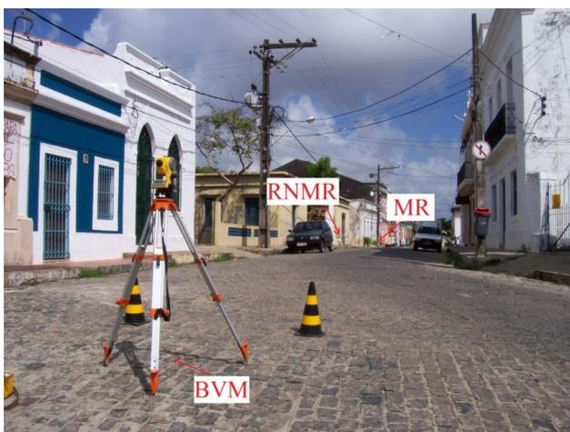
Figura 4.64 – Configuração dos vértices BVM, MR e RNMR. Foto: Dezembro 2011.
