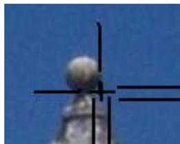
Figura 2.7 - Campo de visão da Estação Total e a medição do alvo esférico com cruz filar projetada na Posição Inversa da luneta.
