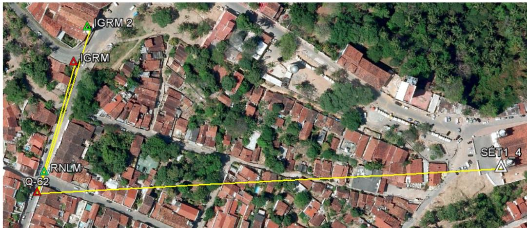
Figura 4.72 – Esboço em vista aérea dos alinhamentos a partir do vértice Q – 62 para os alvos altos. Fonte: *Google Earth* 2009.
