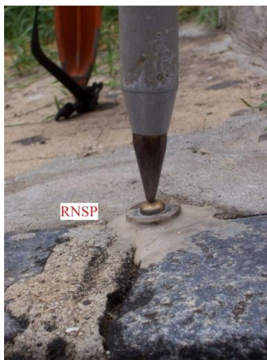
Figura 4.59 – RNSP e superfície de contato com o bastão verticalizado. Foto: Dezembro 2011.
