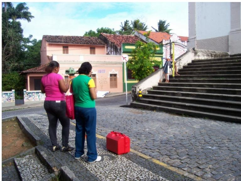
Figura 4.28 – Mira de Ré sobre o ponto auxiliar e segunda estação de nivelamento. Foto: Julho 2011.
