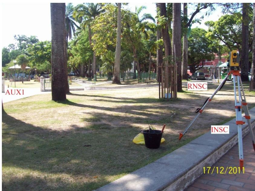
Figura 4.50 – Configuração dos vértices INSC, AUX1 e RNSC. Foto: Dezembro 2011.
