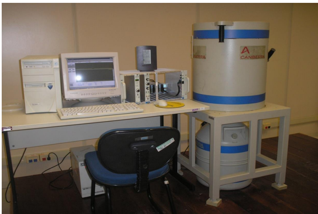
Figura 15 - Sistema de medidas pelo espectromêtro gama de HpGe
