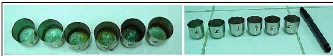
Figura 19: Cadinhos de platina usados na fusão alcalina.
