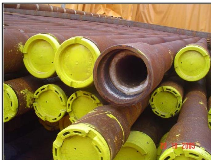
Figura 7: Tubulações com incrustações radioativas estocadas nos pátios da indústria do petróleo.
