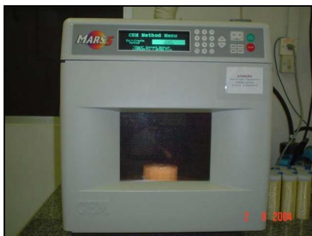
Figura 18: Microondas utilizado para digestão de amostras.
