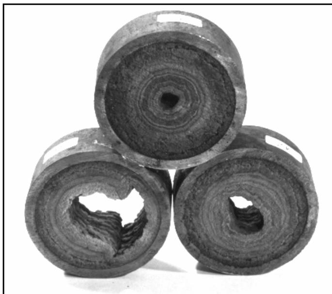
Figura 10: Tubulações usadas na exploração marítima de petróleo, já em estado avançado de incrustação (REQARJ, 1997).
