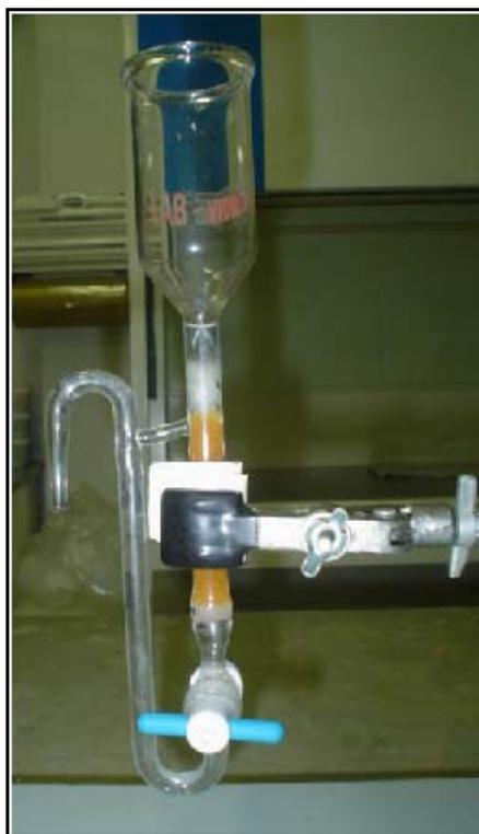
Figura 13: Coluna de vidro de troca iônica.
