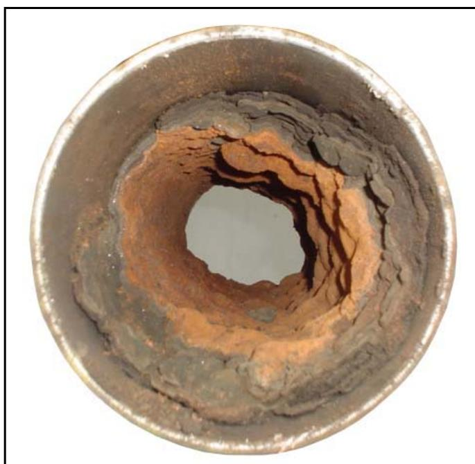
Figura 11: Formação de incrustações no interior da tubulação de água produzida.
