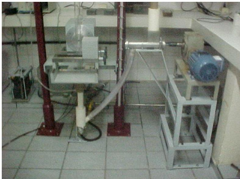
Figura 16 – Sistema de controle e alimentação do fluxo de sólidos para o *riser* do MEF.
