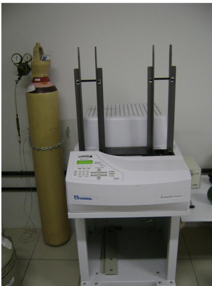
**Figura 7. Detector Tennelec S5E da CANBERRA**
