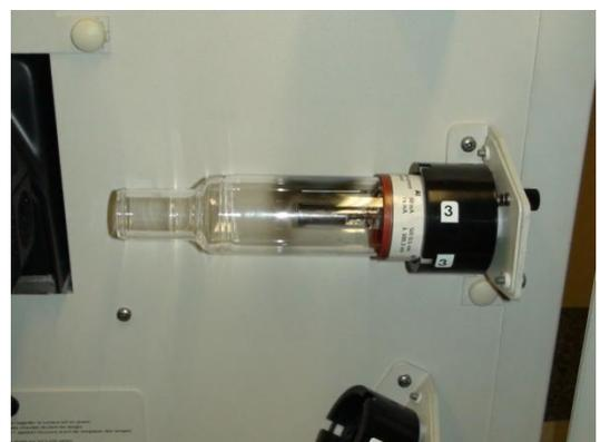
Lâmpada cátodo oco com linha de ressonância 283,3 nm.
