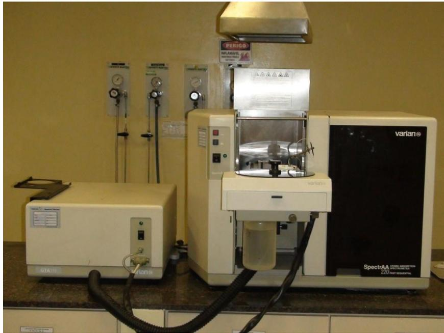
Espectrometro de Absorção Atômica marca Varian, modelo SpectrAA220/FS com acoplamento do forno de grafite e amostrador automático
