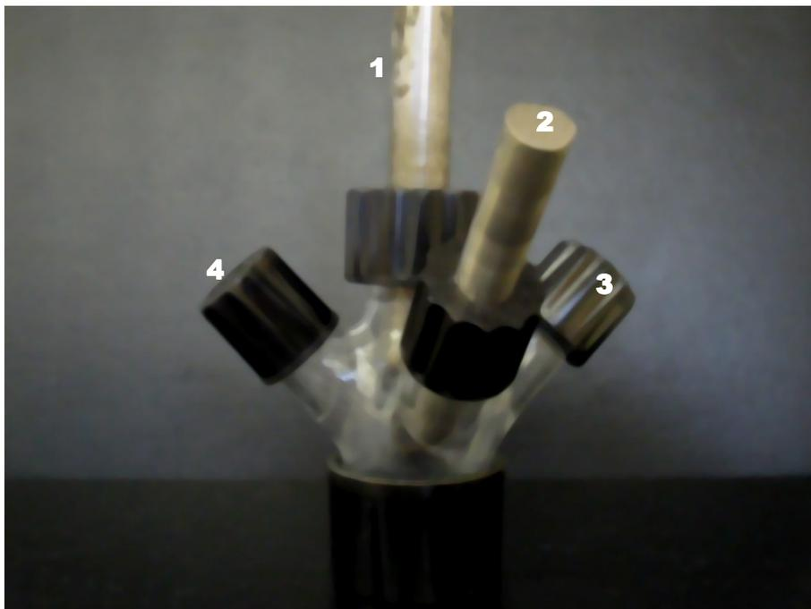
**Figura 4.** Cella eletroquímica: 1) cátodo; 2) Anodo de Ni<sup>0</sup>; 3) Saída para controle de temperatura; 4) Saída de alíquotas.
