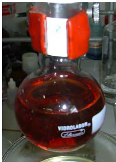
Figura 3.2 – Suspensão de NCs de CdTe recém preparada, apresentando coloração castanha característica do semiconductor.
