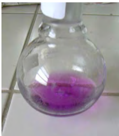
Figura 3.1- Coloração do composto Na-Te-Te-Na(aq), formado pela redução do \text{Te}^0 .
