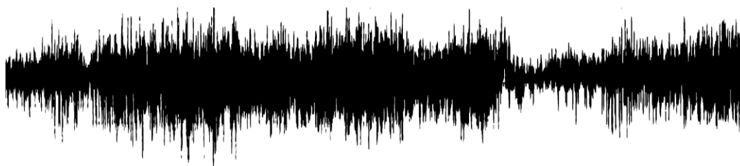
Figura 5 – Representação de parte do registro eletrofisiológico. É possível observar a remoção das linhas de grade do registro, com a imagem binarizada.
