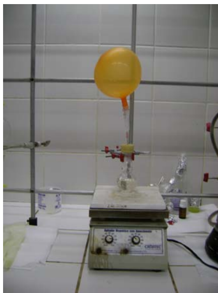
Figura 14. Representação do sistema reacional usado nas sínteses dos complexos com \beta -cetoésteres.
