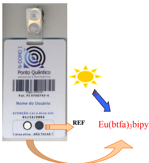
Figura 6. Foto de um nano-dosímetro baseado em complexos contendo \beta -dicetonas [45, 46].
