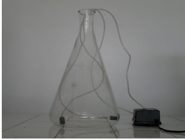
Figura 14. Unidade reacional proposta para o teste de biodegradabilidade.
