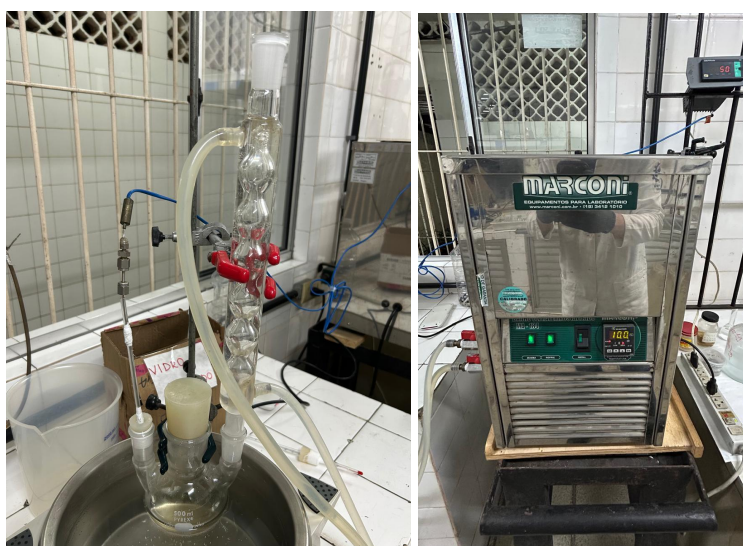
Figura 14 - Configuração e equipamentos para ensaios de corrosão com variação de temperatura em banho termostático
