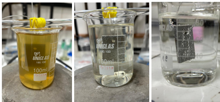
Figura 12- Ensaios de corrosão para diferentes concentrações do extrato da moringa (15%, 5% e 0%) em t = 0,5 hora, C_{HCl} = 1 M e T = 30^{\circ}C
