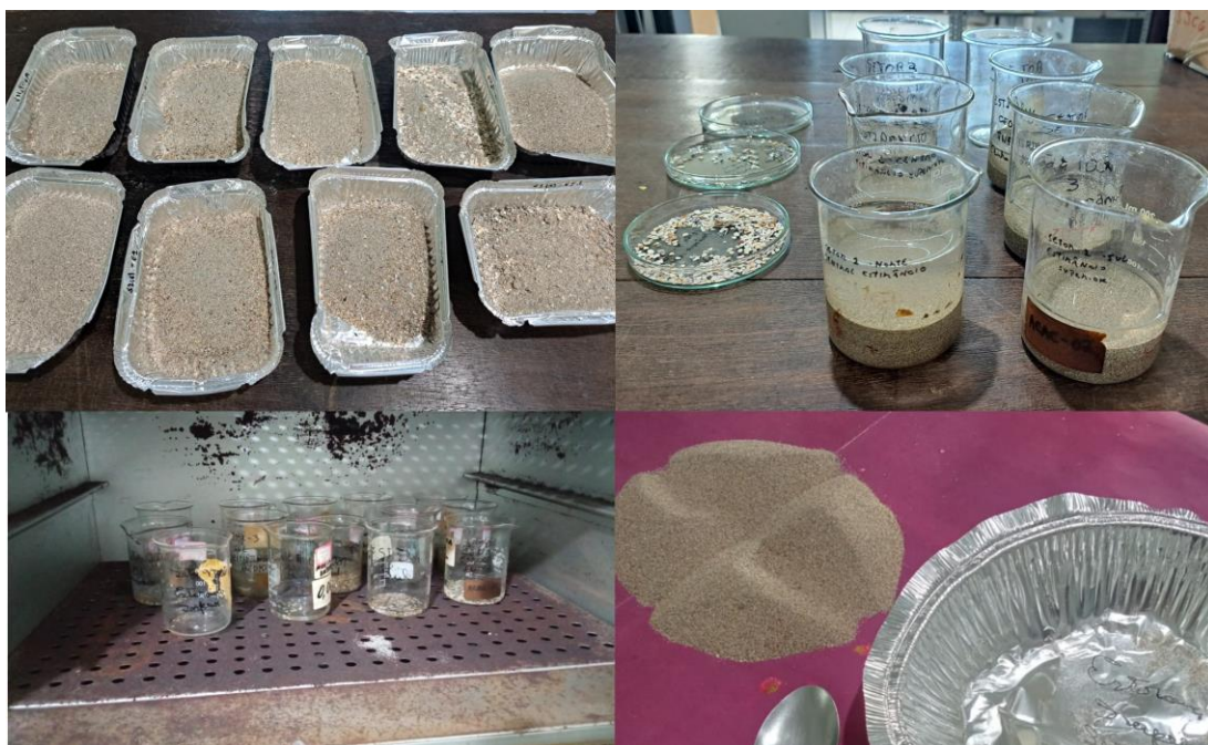
Figura 10 - Imagens procedimentos de separação do tamanho dos grãos feito no LGGM – UFPE
