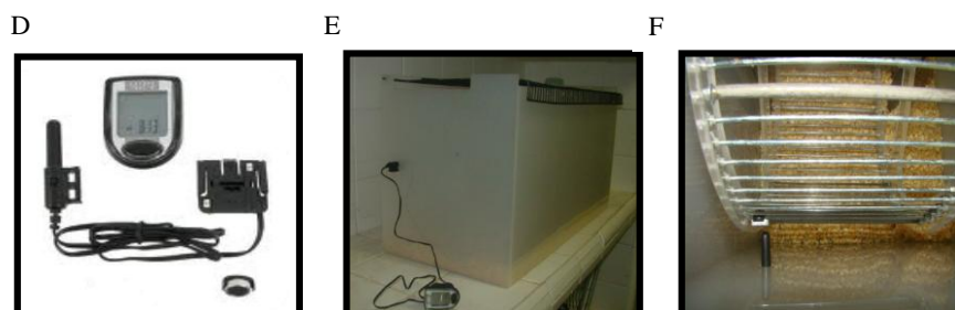
Figura 12. Dimensões da gaiola de atividade física voluntária (A); Gaiola de atividade física voluntária com cicloergômetro e comedouro (B), Cicloergômetro (C), Esquema do funcionamento do ciclocomputador com os sensores [Cataye, model CC-VL810, Osaka, Japan] (D); Posicionamento de um sensor na porção externa da GAFV, acoplado ao ciclocomputador (E); Visão interna dos sensores, um acoplado ao cicloergômetro e outro na GAFV (F).
