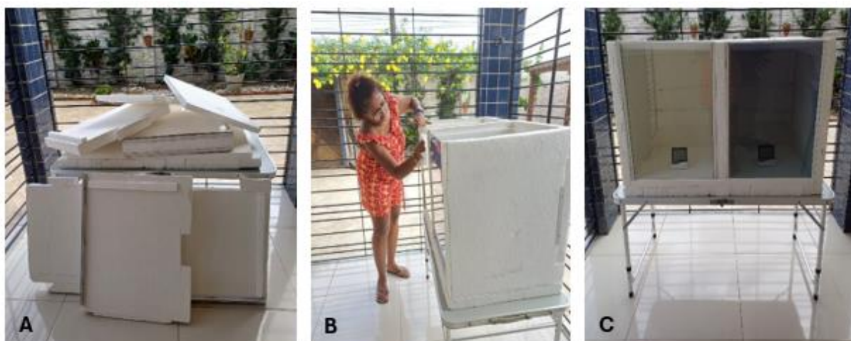
Figura 66 - Protótipo modular A) Caixa desmontada, B) Processo de montagem e C) Caixa montada.
