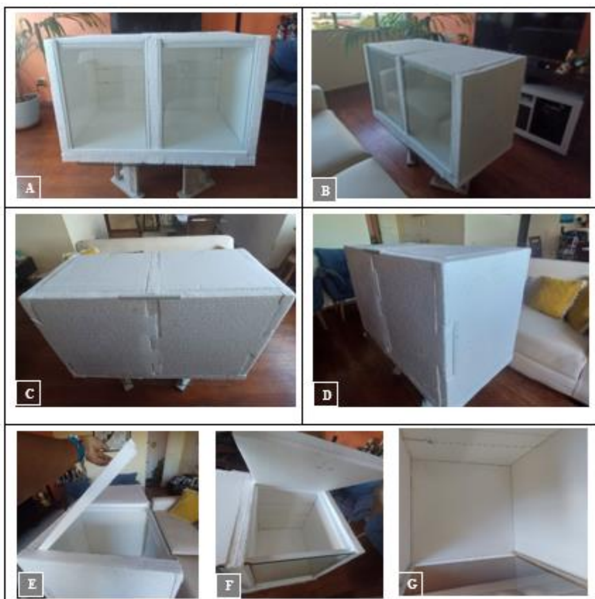
Figura 51 - Desenvolvimento da caixa solar térmica (a) Vista frontal com vidro; (b) Vista lateral isométrica; (c) Vista posterior com encaixes; (d) Detalhe do encaixe sistema macho e fêmea; (e) Abertura da tampa; (f) Caixa sem a tampa; (g) Vista interna da caixa emassada
