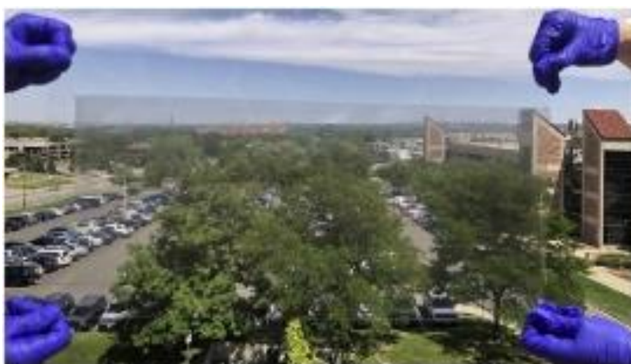
Figura 29 - Filme com pigmentos termocrômico
