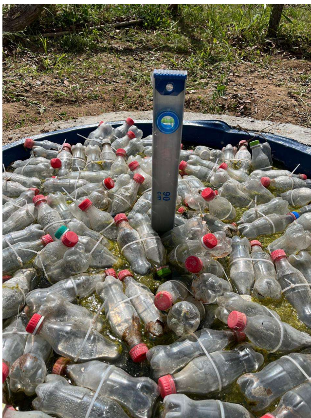
Figura 13 - Exemplificação da medição da lâmina d'água no reservatório
