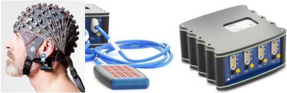
Figura 8. Touca, receptor de 64 canais e amplificador (da esquerda para direita).
