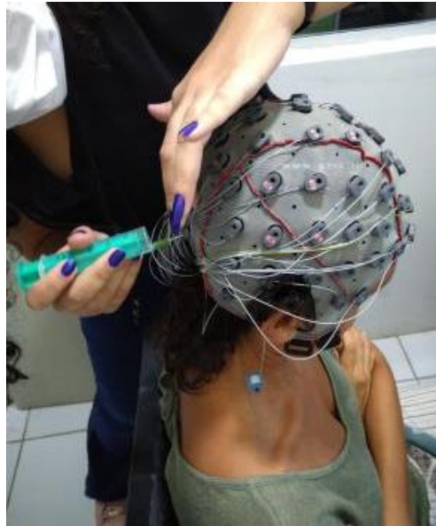
Figura 10. Primeiro teste de uso de equipamento (EEG, 64 canais).
