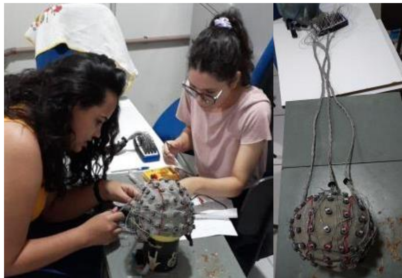
Figura 9. Setup do EEG de 64 canais.
