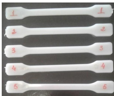
Figura 9 - Fotografia dos corpos de prova do ensaio de tração de acordo com norma ISO 527.
