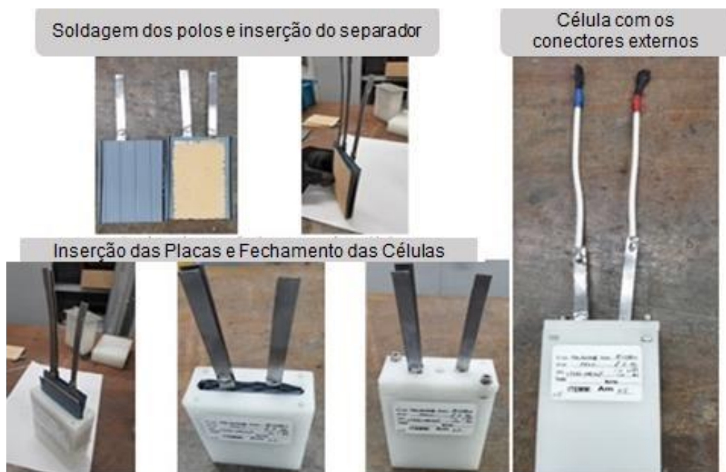
Figura 10 - Esquema da montagem das células Pb-A de tensão nominal de 2V, adotadas para aditivção da placa negativa.
