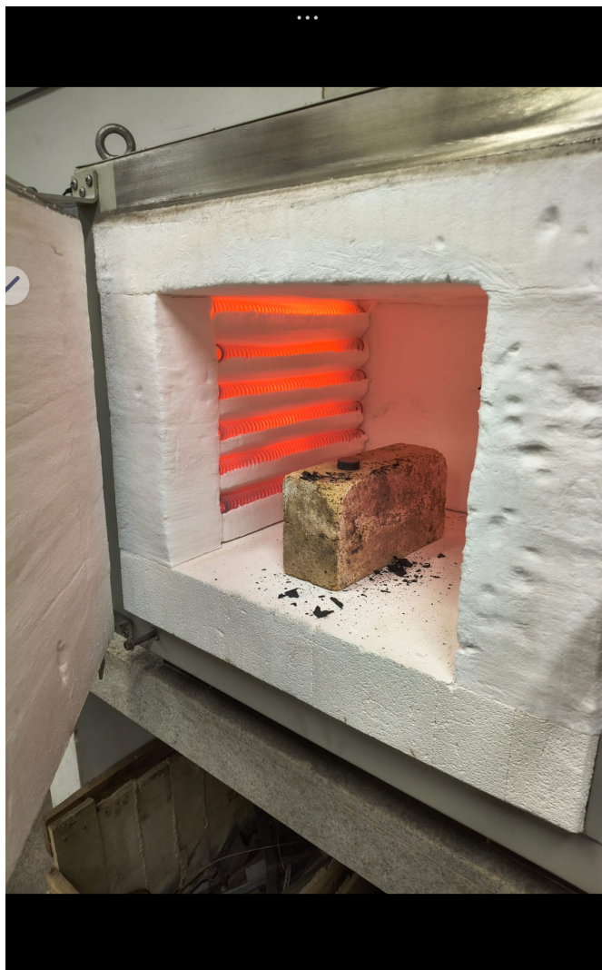
Figura 11 - Forno Jung LF4212 utilizado durante o tratamento térmico
