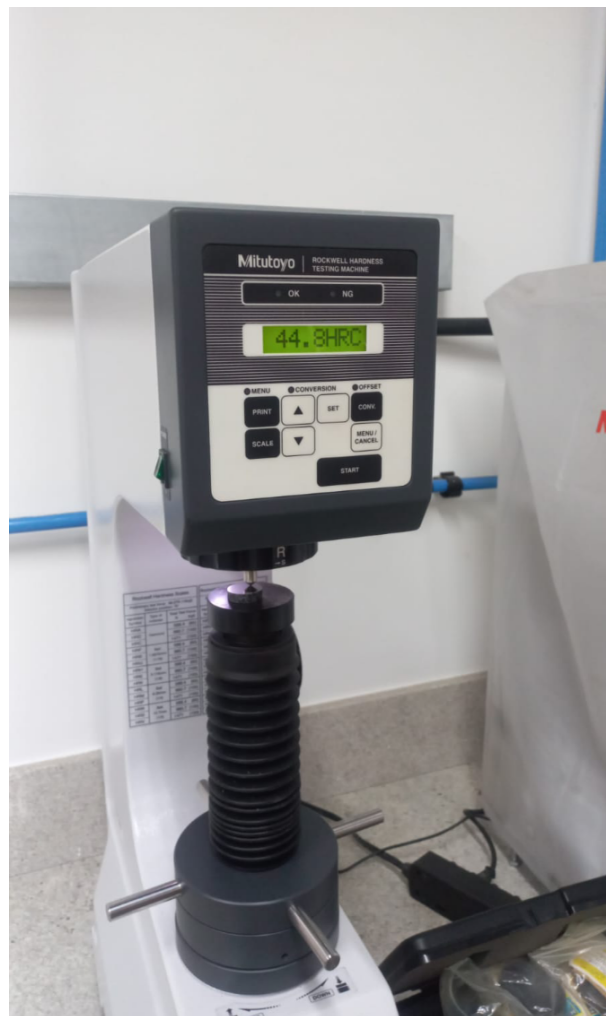
Figura 21- Medição de dureza da amostra submetida a tratamento de 1050°C.
