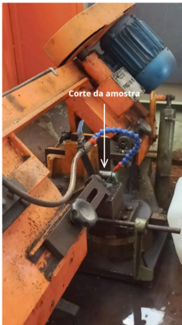
Figura 10 - Corte da peça de Ti-6Al-4V para a elaboração dos corpos de prova
