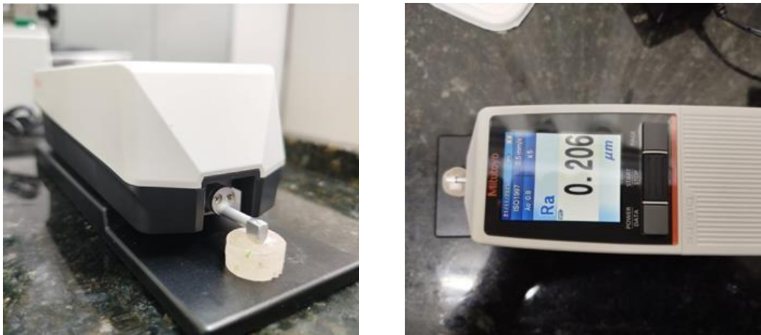
Figura 5 - Avaliação da rugosidade no rugosímetro portátil Mitutoyo SJ-210
