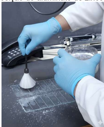
Figura 23: Deposição do aluminato de zinco dopado com térbio.
