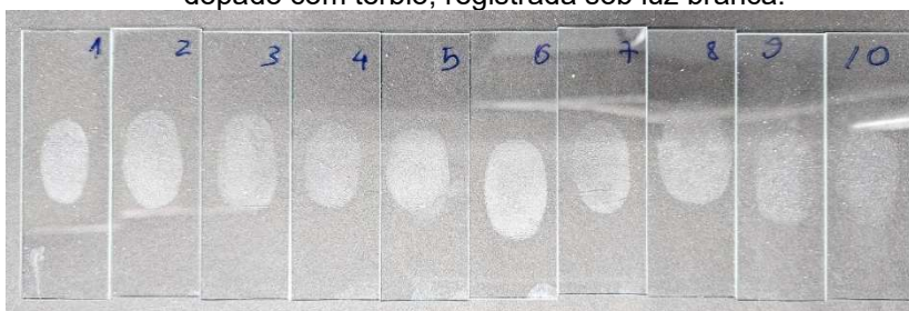
Figura 24: Imagem das impressões digitais sebáceas reveladas com o aluminato de zinco dopado com térbio, registrada sob luz branca.
