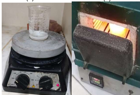
Figura 12: Formação do gel (a) e chama do processo de combustão (b). (a) (b)
