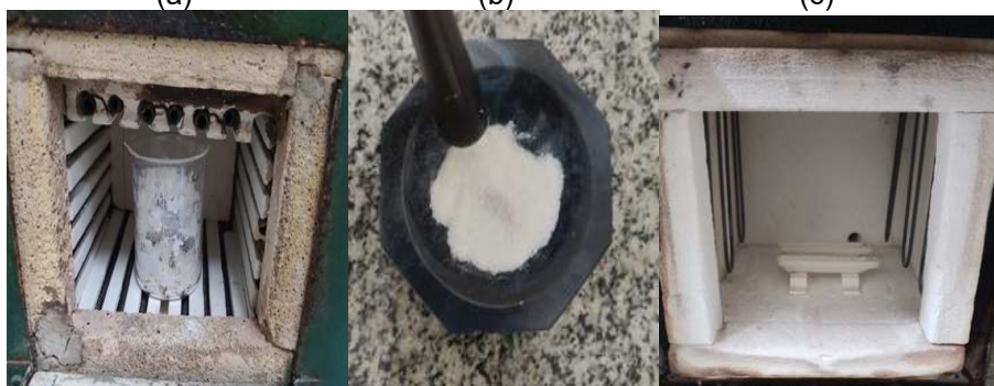
Figura 13: Material pós combustão (a), pó macerado (b) e processo de sinterização (c).
