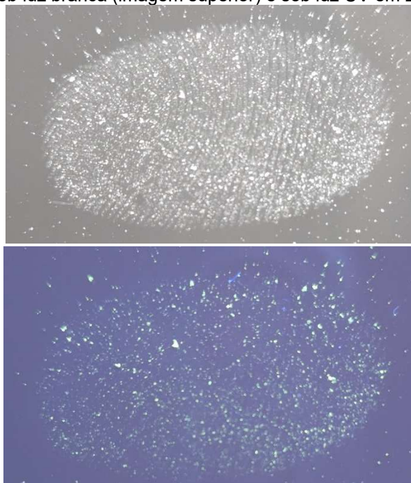
Figura 26: Comparação entre uma IDL sebácea revelada com aluminato de zinco dopado com térbio: registrada sob luz branca (imagem superior) e sob luz UV em 254 nm (imagem inferior).
