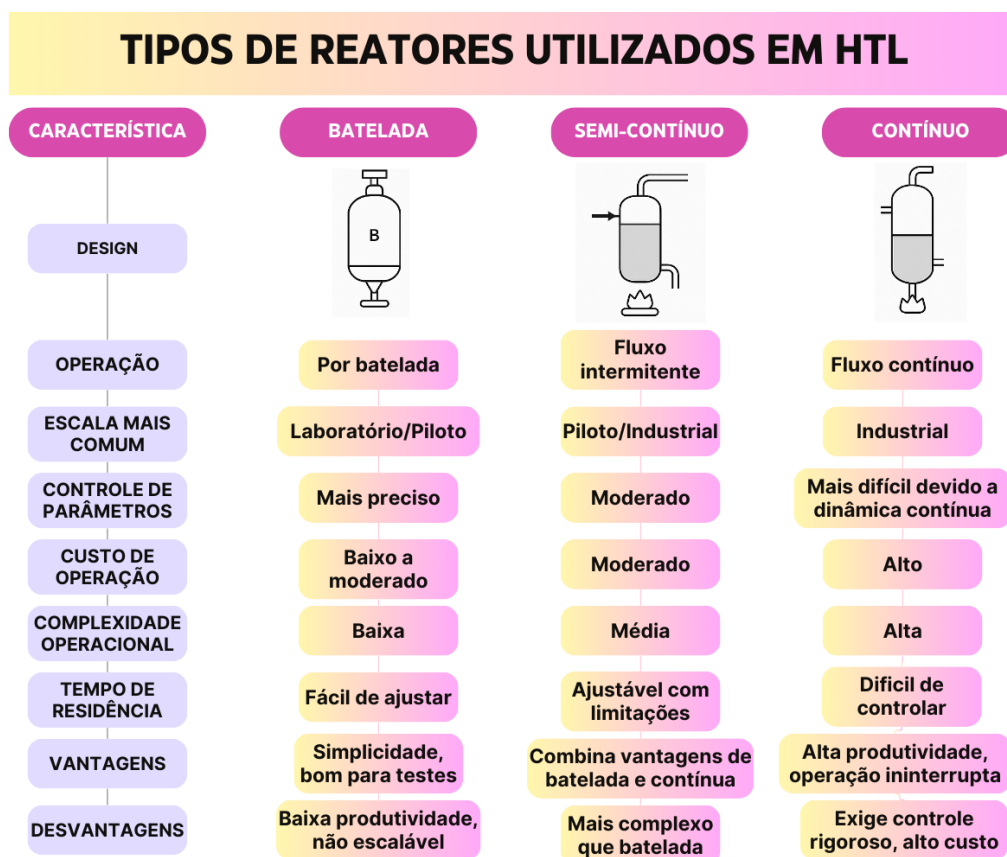
Figura 10: Comparação entre os principais tipos de reatores utilizados em LT quanto à operação, controle e aplicação.
