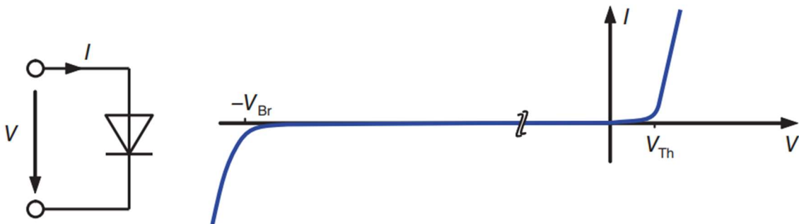
Figura 5 – Símbolo e curva I-V característica do diodo p-n.
