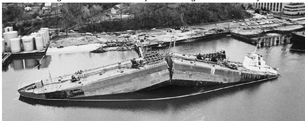
Figura 14 – Fratura transição dúctil-frágil do navio Liberty
