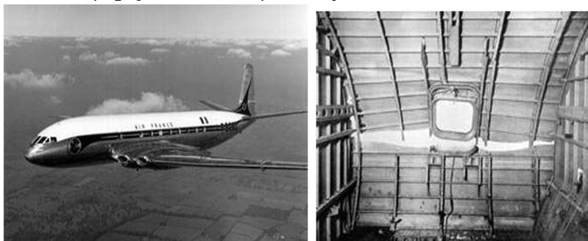
Figura 12 – Propagação da trinca a partir da janela do avião Comets da Havilland
