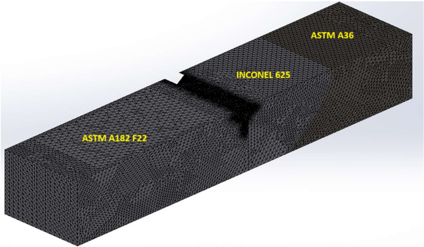
Figura 85 – Refino da Malha e Controle de Malha na Região de Entalhe
