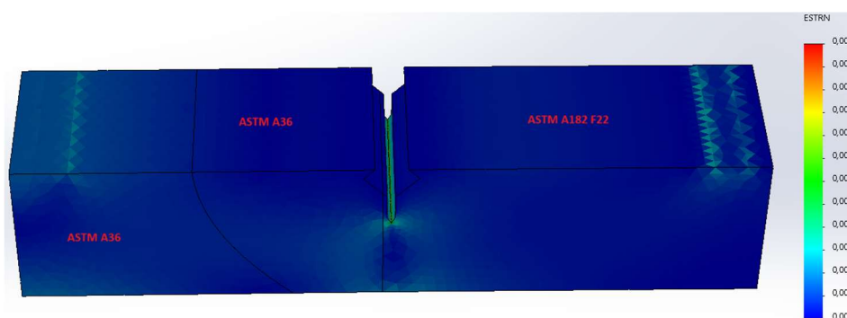
Figura 71 – Deformação Equivalente de Von Mises (Plastificação).
