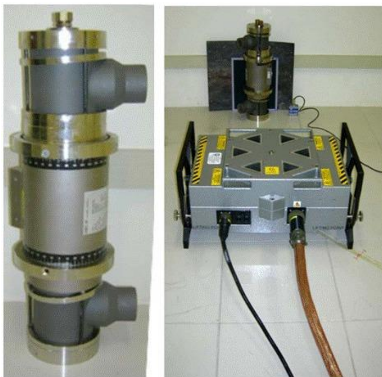
Figura 2-27- (Esquerda) Uma foto do tubo de raios-X e (direita) o radiador do Betatron localizado a 1 metro do tubo de raios-X contendo chumbo dentro para obter uma imagem radiográfica com raios-X de 7,5 MeV.
