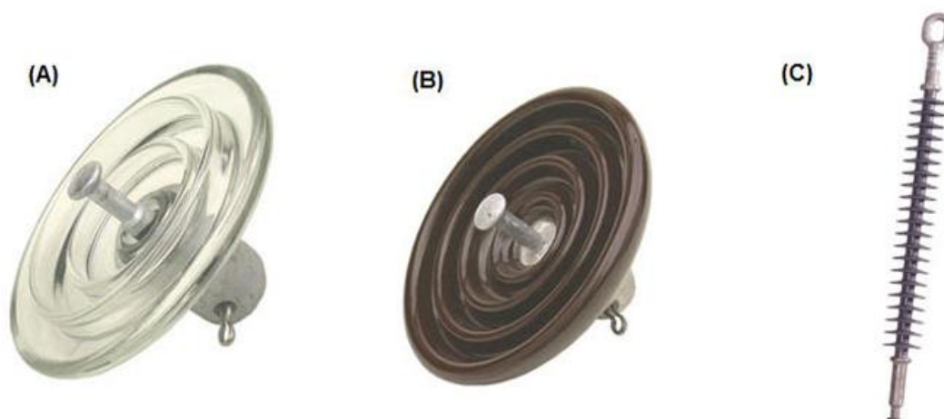
Figura 2-5- Isoladores de linhas de transmissão de energia: (A) isolador de vidro, (B) isolador de porcelana e (C) isolador de compósito.
