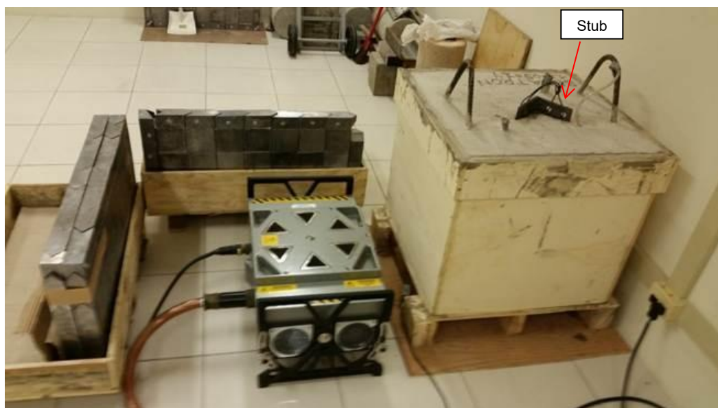
Figura 4-17- Arranjo experimental para radiografia concreto armado de uma fundação da torre metálica autoportante.
