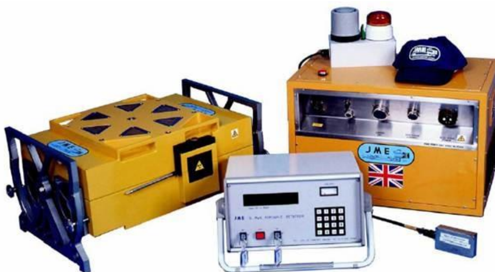
Figura 4-1- Equipamentos que compõem o betatron e uma tabela de especificações técnicas fornecidas pelo fabricante.
