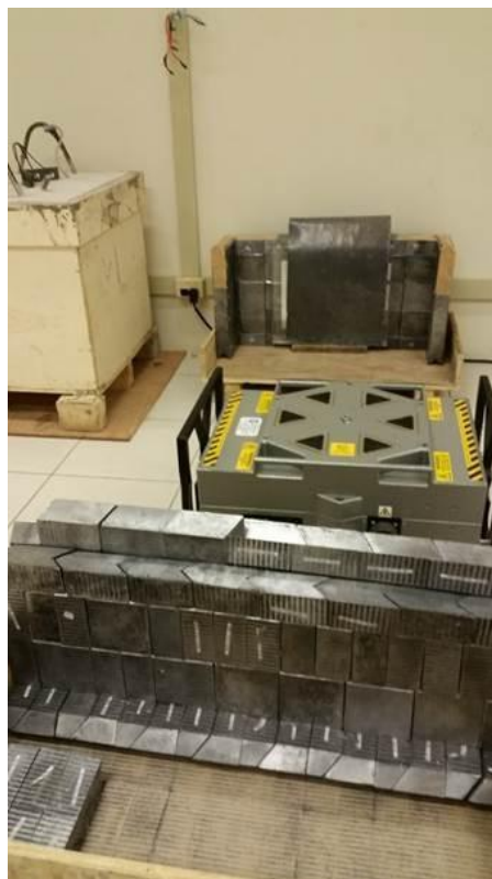
Figura 4-4- Parte dos tijolos de chumbo montados na forma de parede para realizar os ensaios no CRCN.
