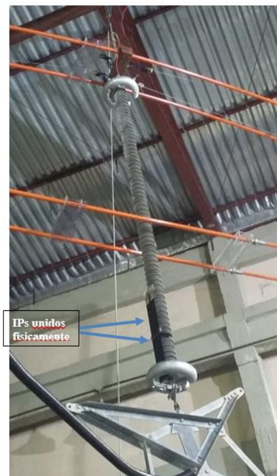
Figura 2-23- Dois IPs unidos fisicamente e posicionados junto ao isolador polimérico com fita adesiva.
