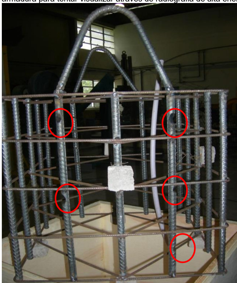
Figura 4-15- Armadura de aço e no interior com cantoneira em “L” de abas iguais, de dimensão similar do “pé” da torre metálica autoportante, vazios (tubos) e defeitos (perda de massa) introduzidos na armadura para tentar visualizar através de radiografia de alta energia.
