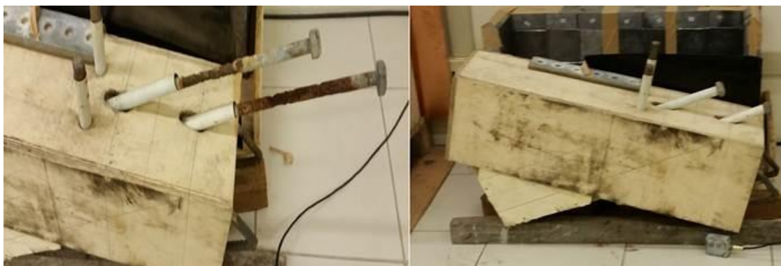
Figura 4-25- Parafuso corroído no lugar do tirante inclinado de sustentação da cruzeta.
