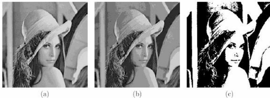
Figura 3-35- Representação de uma imagem digital com profundidades (a) 8, (b) 4 e (c) 2 bits por pixel.
