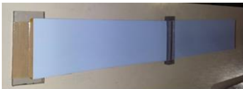
Figura 2-22- Dois IPs unidos fisicamente usando policarbonato resultando em torno de 85 cm de comprimento.
